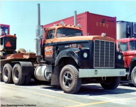
*Der Dodge Big Horn war einer der größten US-Trucks mit wahrscheinlich der längsten Schnauze. Sie hatten Cummins Diesel mit bis 600 PS. Die Ausführung mit kürzerer Schnauze hieß Short Horn und hatte ca. 350 PS.*
