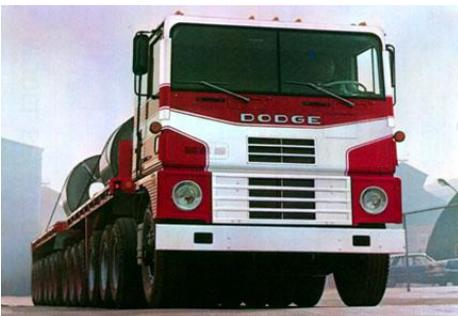
*Nur von 1970 – 74 gebaut: Dodge 1000 Tilt Cab COE mit kippbarer Kabine aus Alu und Bugeinsatz aus Plast. Der Detroit Diesel hatte 335 PS. Zählt einmal die Räder dieses Trucks. Es sollen 50 sein.*
